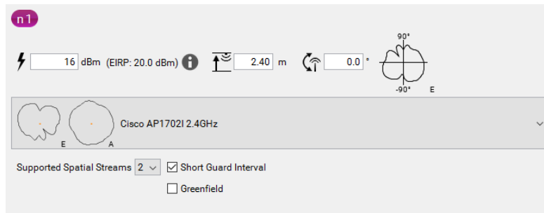
Slika 33: Podešavanje snage prenošenja signala za 2,4 GHz
