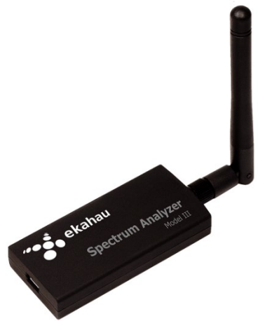
Slika 7: Ekahau uređaj za analizu spektra [9]
