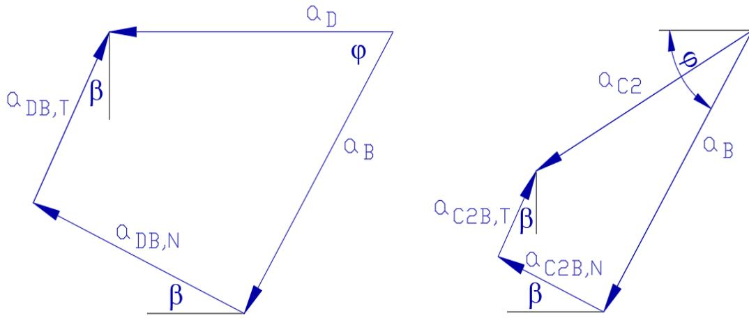
Slika 4.6 – Vektorski zbroj ubrzanja točke D (lijevo) i C<sub>2</sub> (desno)
