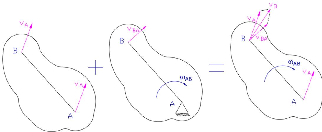
Slika 2.4 – Zbroj vektorskih komponenti brzine točke B
