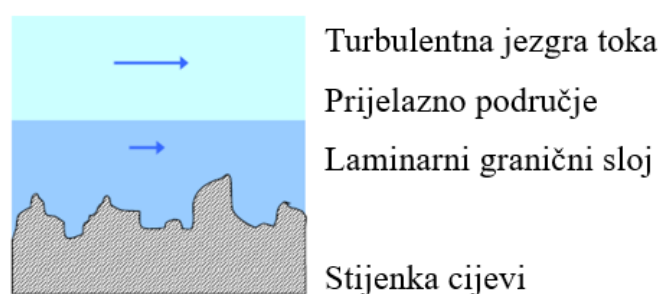
Slika 2.2 – Zone strujanja (laminarno i turbulentno) i hrapavost stijenke [2]
