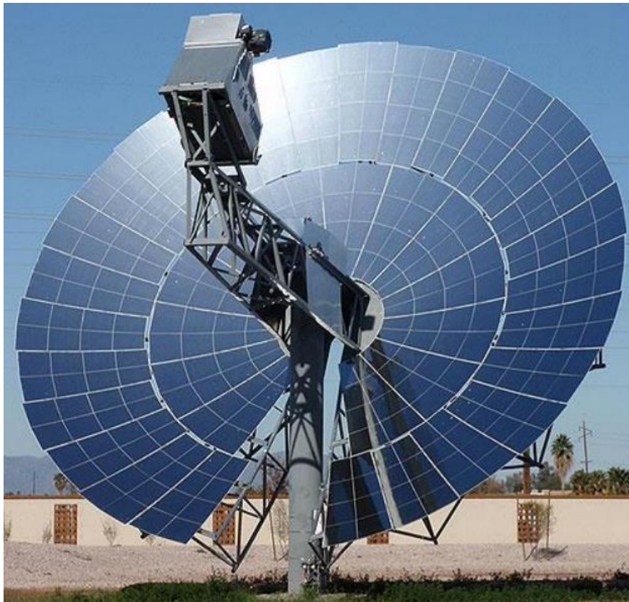
Slika 2.6. Koncentrirajući fotonaponski sustav [3]
