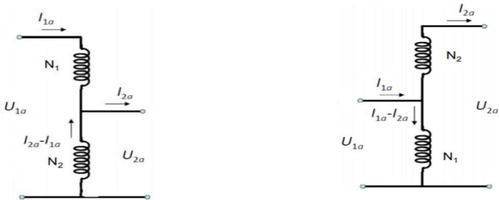
Slika 4.2. 1. Silazni i uzlazni autotransformator [5]
