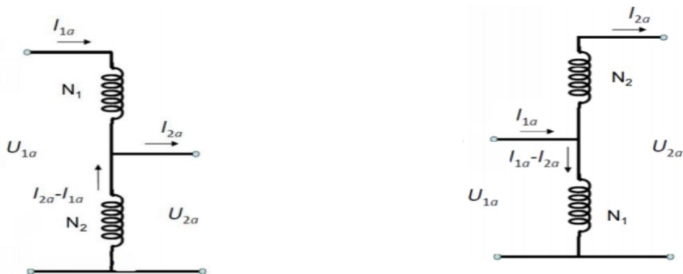
Slika 4.2. 1. Silazni i uzlazni autotransformator [5]
