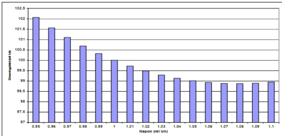
Slika 8.2.3. Ovisnost dnevnih gubitaka o pogonskom naponu u nadzemnoj mreži [13]
