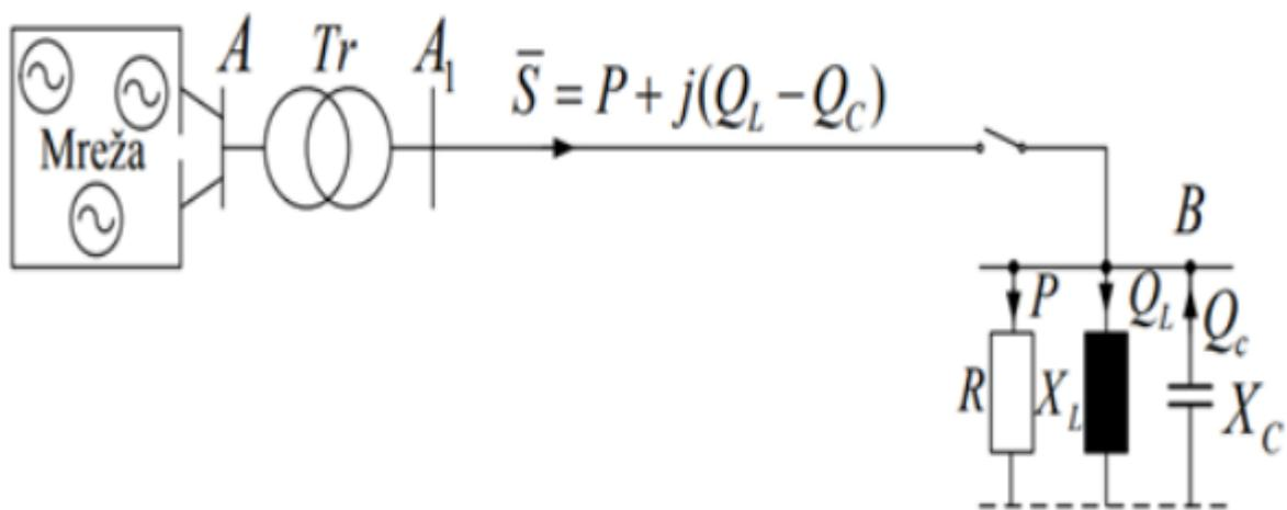
Slika 7.2.1. Prikaz spajanja kondenzatora uz trošilo [7]
