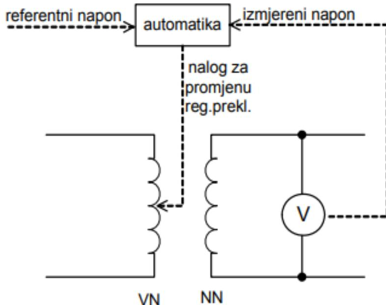
Slika 6.2.2. Princip rada automatske regulacije napona na transformatoru [7]
