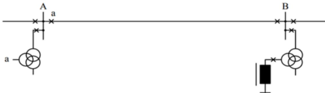
Slika 7.4.2. Kompenzacijnska prigušnica spojena na tercijar transformatora [5]
