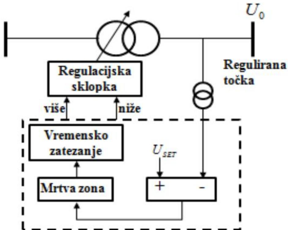
Slika 6.2.3. Shema relajnog regulacijskog transformatora [7]
