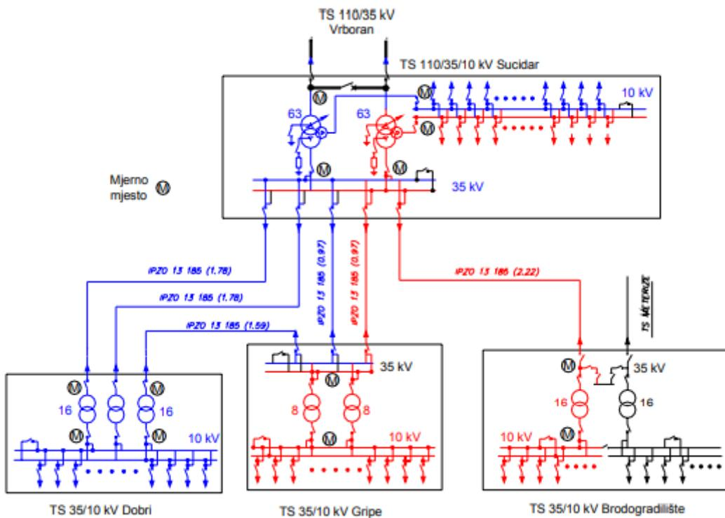
Slika 9.1. Elektroenergetski sustav s prikazom mjernih mesta [14]
