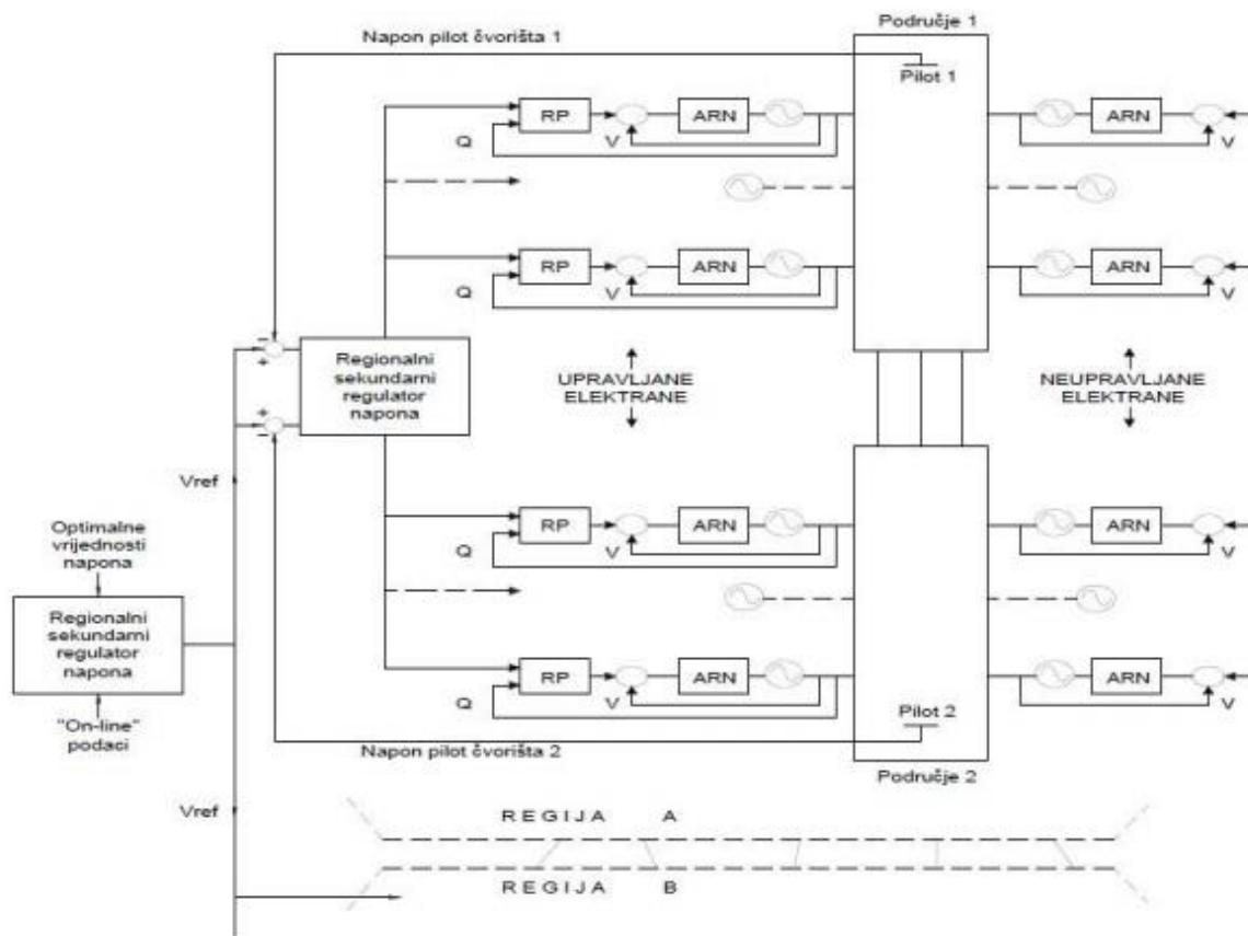
Slika 5.2. Pojednostavljena shema hijerarhijskog sustava upravljanja naponom [4]
