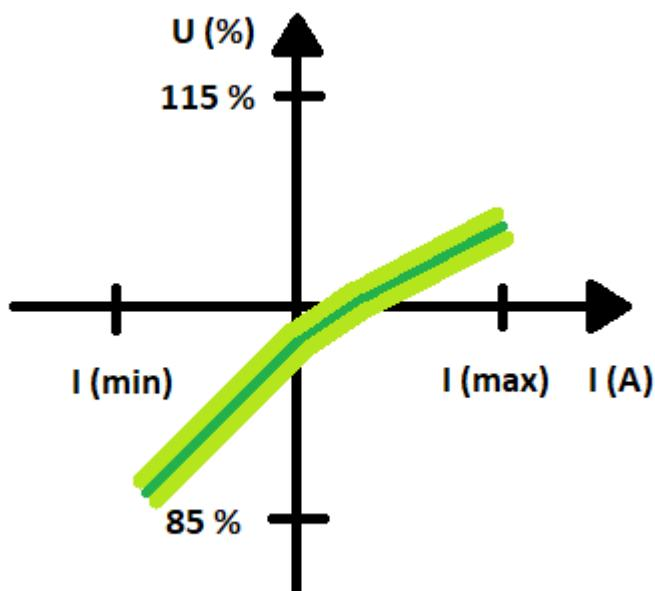
Slika 6.2.6. Usmjereno strujno zavisna karakteristika automatske regulacije napona
