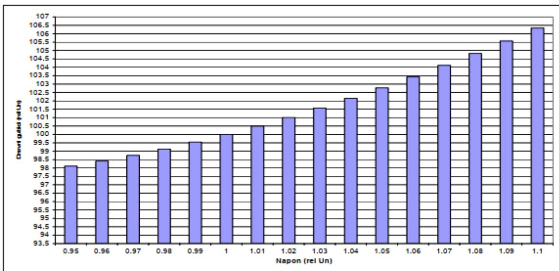
Slika 8.3.1. Ovisnost dnevnih gubitaka o pogonskom naponu u 20 kV mreži
