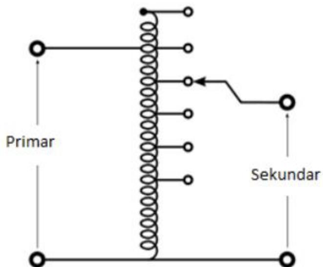
Slika 4.2.2. Regulacijski transformator [5]
