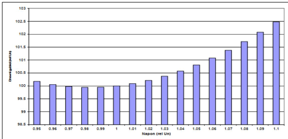
Slika 8.1.3. Ovisnost dnevnih gubitaka o pogonskom naponu u kabelskoj mreži [13]
