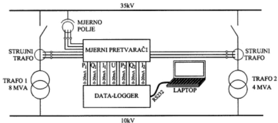
Slika 9.2. Shema mjerjenja i mjerna oprema [14]
