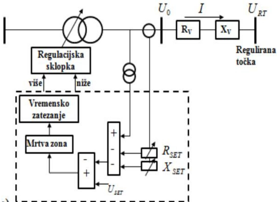
Slika 6.2.4. Shema regulacijskog transformatora sa strujnim mjernim transformatorom [7]
