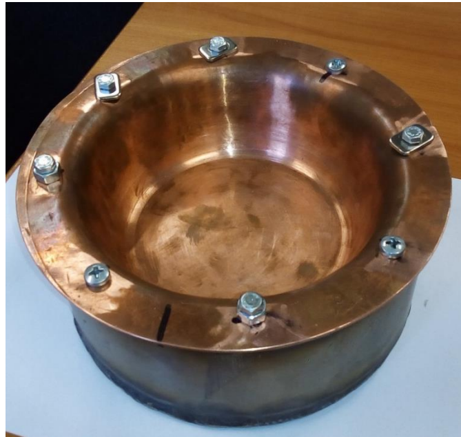
Slika 3.3. – Konkavna prednja površina grijača izrađena od bakra
