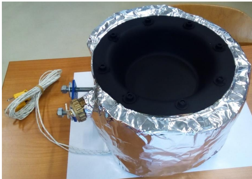
Slika 3.4. – Grijač nakon izoliranja i bojenja prednje površine
