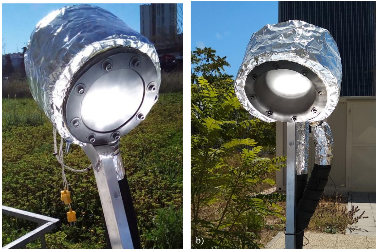
Slika 4.9. – Fokusiranje Sunčevog zračenja na grijaču: a) ravni grijač [3], b) konkavni grijač
