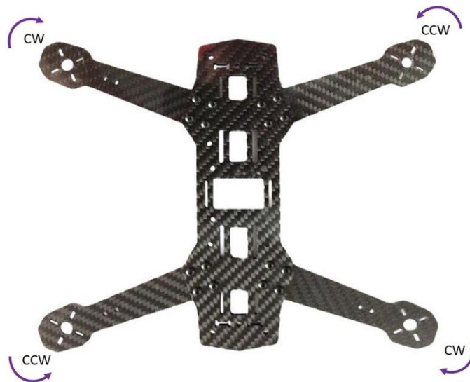
Slika 27. Smjer vrtnje propelera tj. motora
