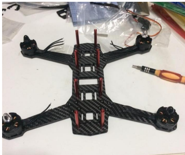
Slika 25. Tijelo letjelice korišteno u radu
