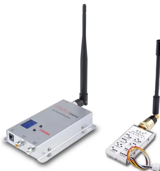
Slika 10. Primjer predajnika desno i prijammnika lijevo [24]
