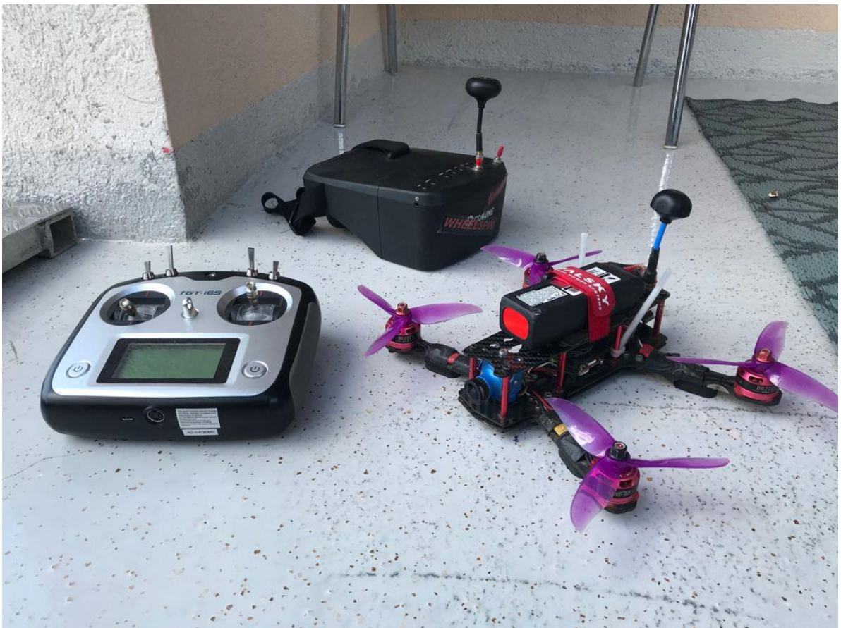
Slika 33. Višemotorna bespilotna letjelica s video vezom i sustavom za upravljanje
