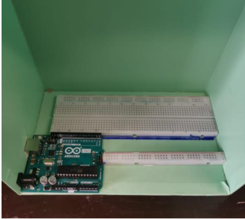
Slika 7.1 – Postavljanje Arduina u kućište
