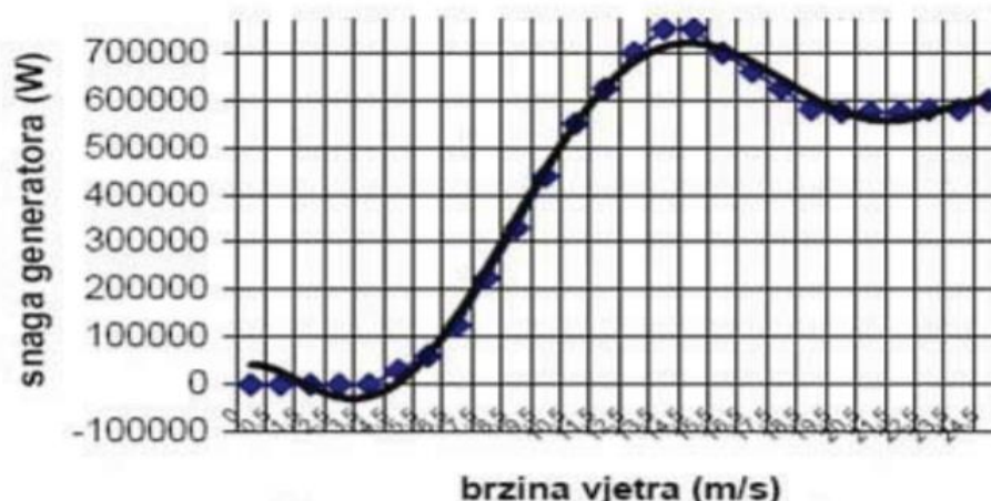
Slika 2.5.- Ovisnost snage vjetrogeneratora o brzini vjetra [12]
