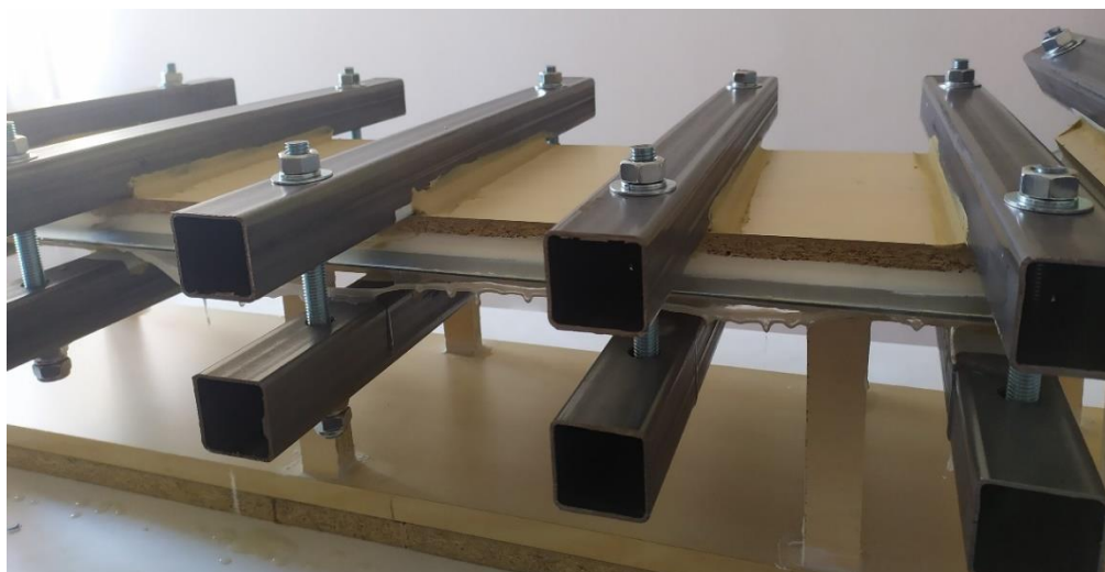
Slika 5.24 - Curenje viška smole iz kalupa
