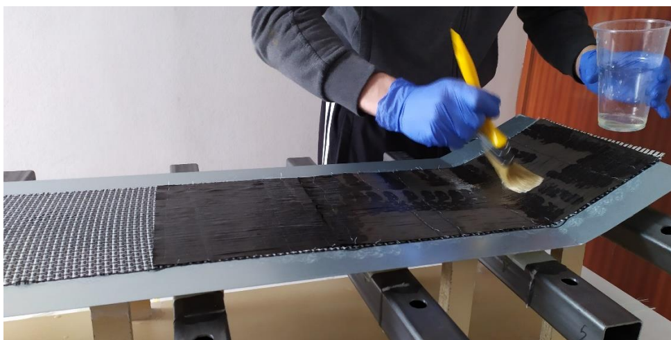
Slika 5.23 - Ručno laminiranje tkanina od ugljičnih i i Innegra™ S vlakana
