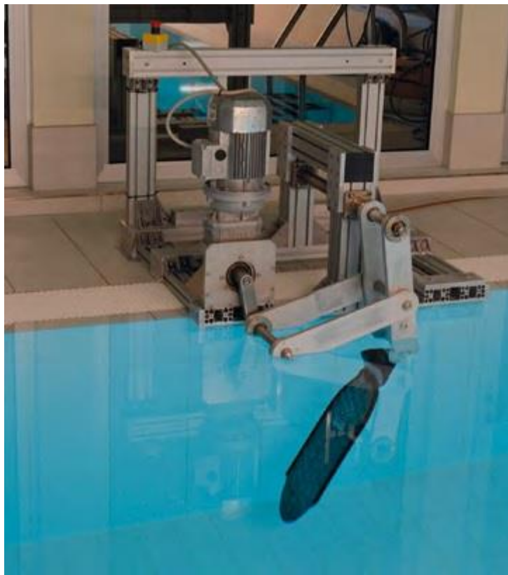
Slika 1.12 - Ispitivanje dinamičke čvrstoće peraja [10]
