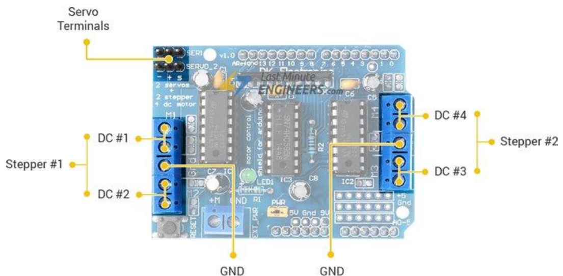
Slika 4.22. Raspored izlaznih stezaljki za priključak motora [35]
