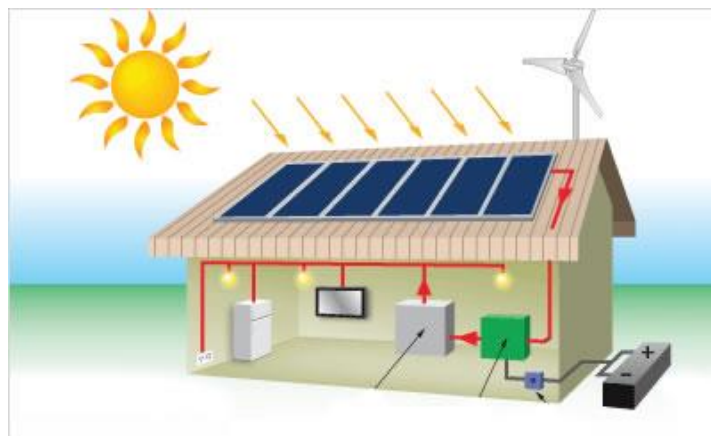
Slika 2.2. Otočni fotonaponski sustav [2]
