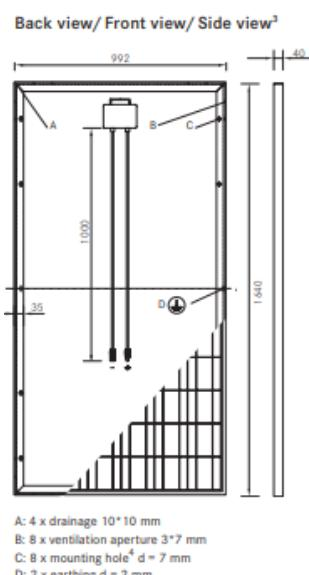
*Slika 4.4. Izgled i dimenzije fotonaponskog modula [8]*
