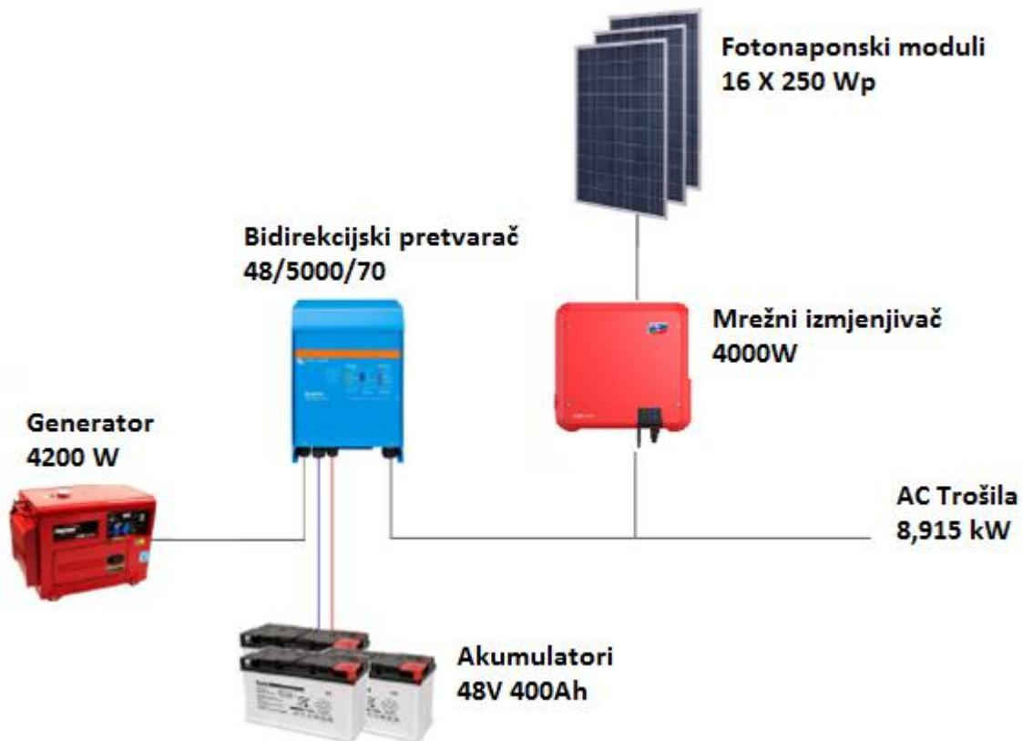
*Slika 5.1. Konačni izgled "novog" otočnog fotonaponskog sustava*
