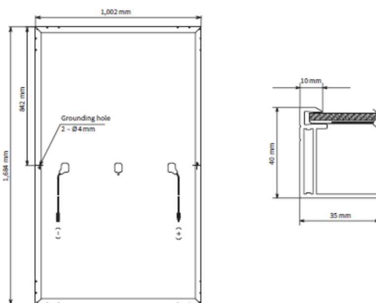
*Slika 4.13. Dimenzije fotonaponskog modula [11]*
