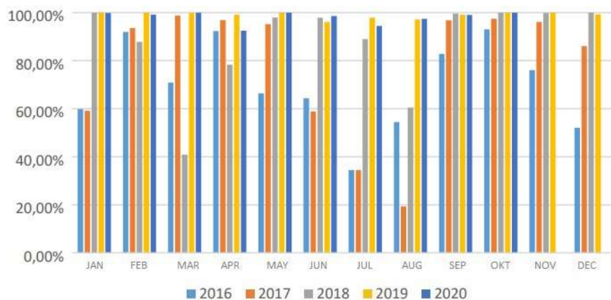
Slika 4.6. Mjesečni rad TS Sarajevo 10 (400 kV) pri povišenim naponima tijekom 5 godina
