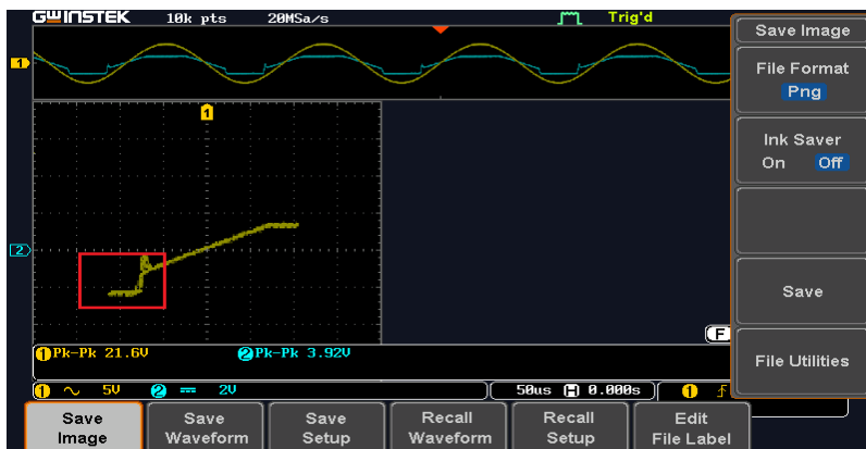
Slika 5.15. Prijenosna karakteristika automatske kontrole pojačanja s integratorom prikazana na osciloskopu
