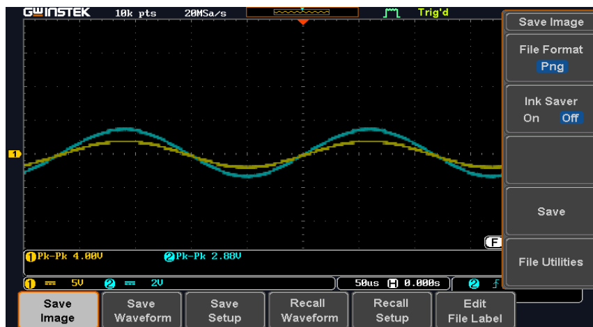
Slika 5.11. Ulazni i izlazni napon pri ulaznoj amplitudi U_{ulm} = 2\text{ V}
