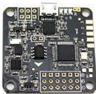
Slika 3.14. Pločica za kontrolu leta NAZE32 Rev5
