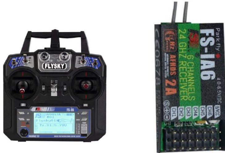
Slika 4.1. Radio odašiljač (RC) i Prijemnik (TX)
