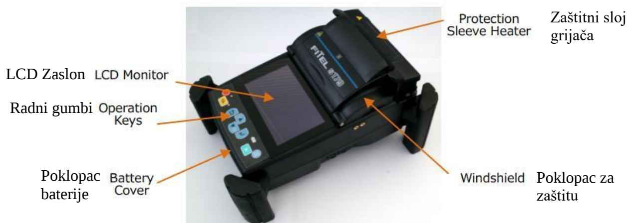
Slika 3.2. Dijelovi spajача optičkih niti
