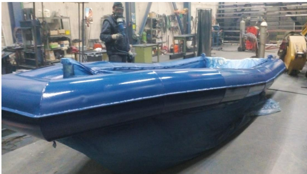
Slika 3.11 Nanošenje podvodne zaštite i završnog premaza [1]
