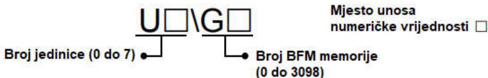
Slika 3.4. Instrukcija za odabir jedinice PLC sustava i BFM memorije [8]
