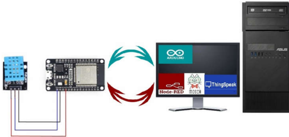
Slika 4.17. Prikaz sustava za ThingSpeak implementaciju
