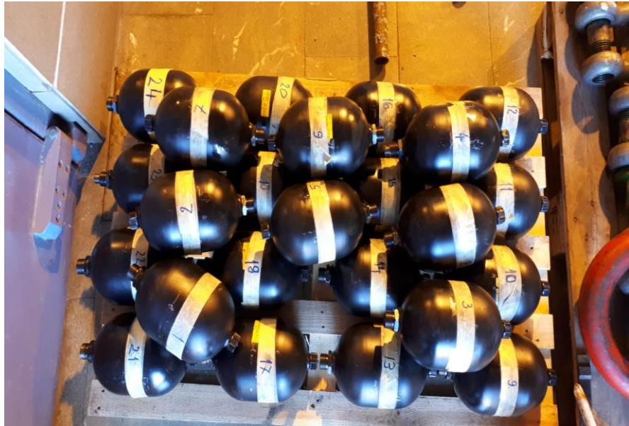
Slika 4. 26. Hidraulički akumulatori [15]
