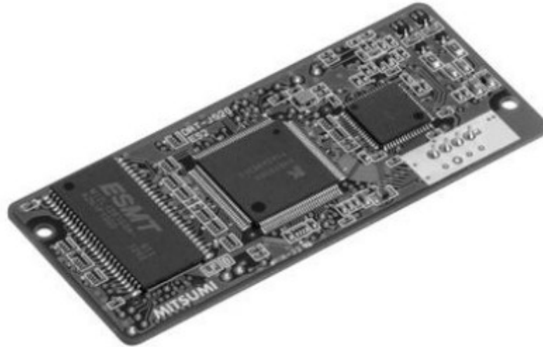
Slika 4.5. HD-PLC Modul DRT-J550
