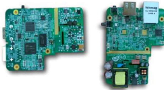
Slika 4.4. Merryvale G.hn PLC modul
