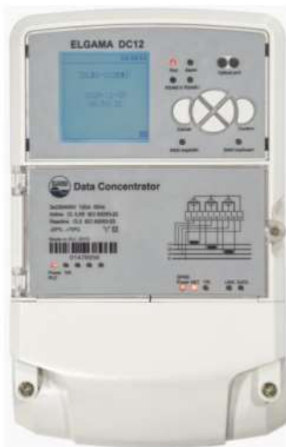
Slika 4.1. ELGAMA DC12 podatkovni koncentrator
