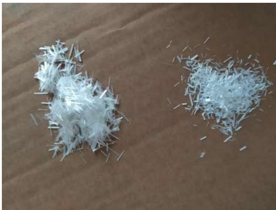
Slika 3.3 Staklena vlakna duljine 3 i 6 mm
