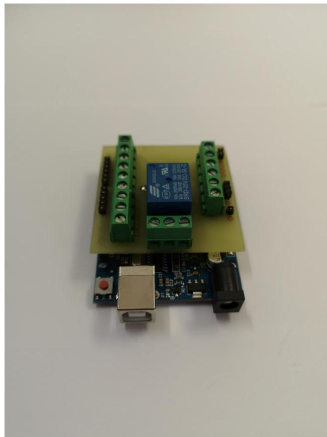
Slika 30 - Sučelje spojeno na Arduino Uno
