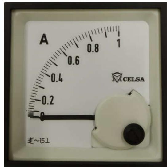
Slika 4.11. Ampermetar
