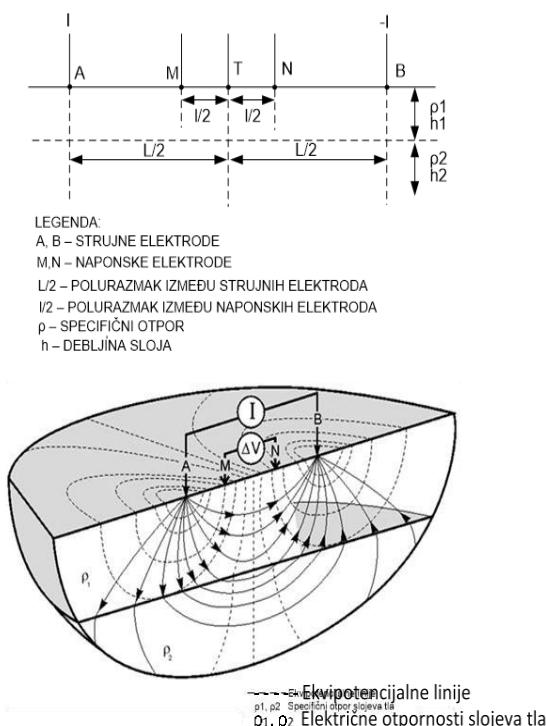
Slika 3.2 Vertikalno električno sondiranje nad slojevitim tlom
