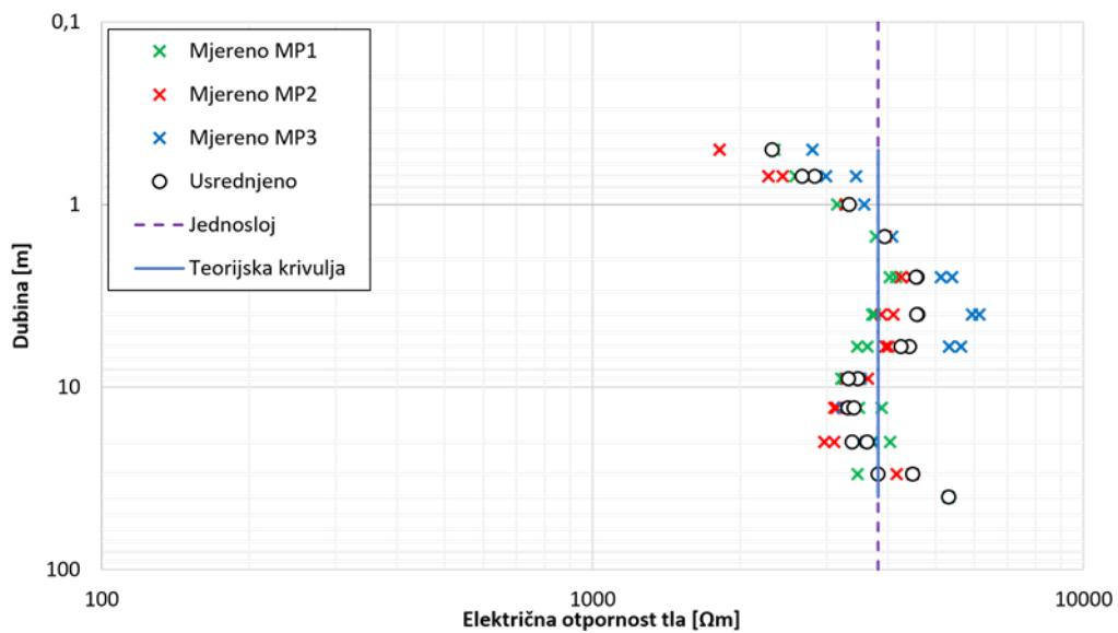
Slika 4.12 Mjerne točke, krivulja sondiranja i model tla na planiranoj lokaciji KS Prapratna
