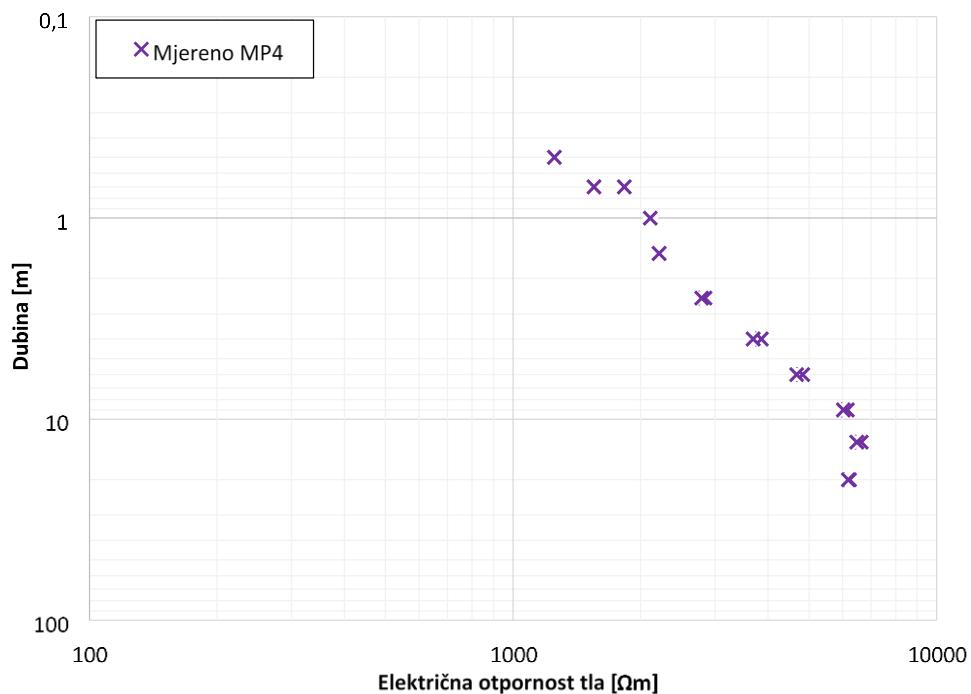
Slika 4.11 Grafički prikaz izmjerениh rezultata električne otpornosti na lokaciji KB spojnice - Prapratna
