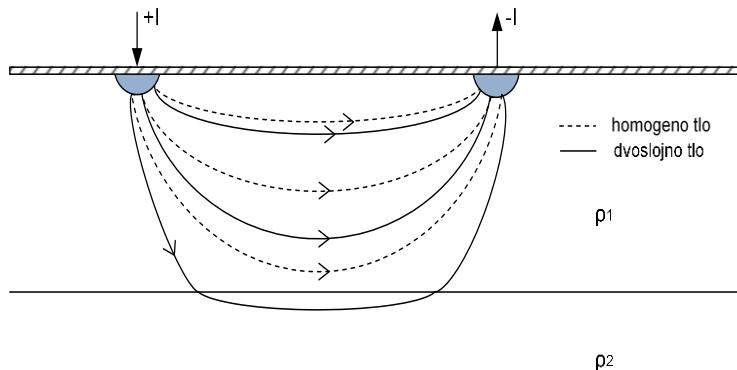
Slika 3.4 Karakteristike toka struje kroz tlo za slučajeve homogenog tla i dvoslojne horizontalne slojevitosti tla ako je  $\rho_1 > \rho_2$
