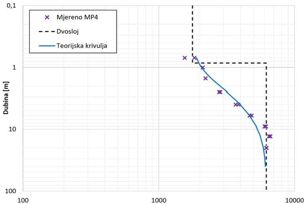
Slika 4.13 Mjerne točke, krivulja sondiranja i model tla na planiranoj lokaciji KB spojnice – Prapratna
