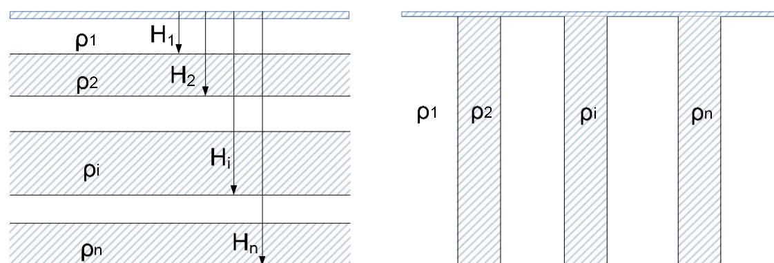
Slika 3.1. Idealna horizontalna odnosno vertikalna slojevitost tla
