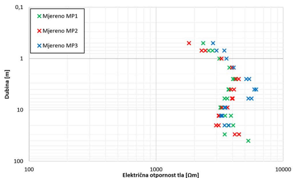
Slika 4.10 Grafički prikaz izmjerenih rezultata električne otpornosti na lokaciji planirane KS
