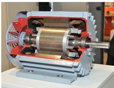
Slika 2. Presjek asinkronog motora sa kliznim kolutima [5]
