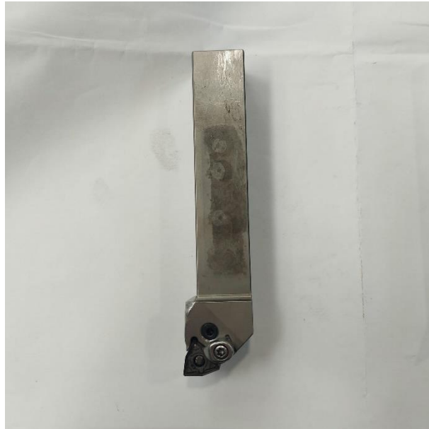
Slika 7.3.1. Alat za grubu obradu tokarenja lijeve orijentacije
