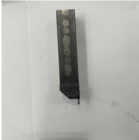
Slika 7.3.3. Alat za izradu kanala
