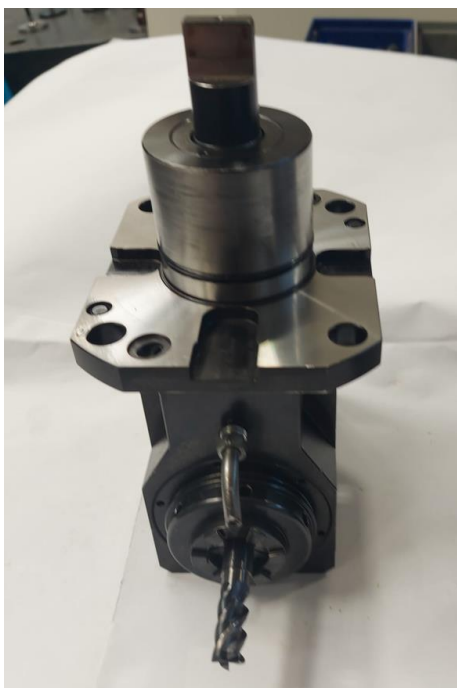
Slika 7.3.5. Alat za glodanje utora sa nosačem
