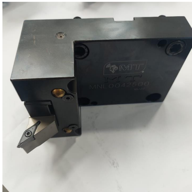
Slika 7.3.2. Alat za finu obradu lijeve orijentacije sa nosačem
