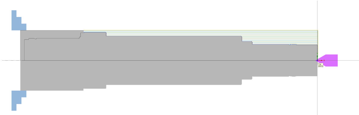
Slika 7.1.1. CAM model osovine u prvom zahvatu
