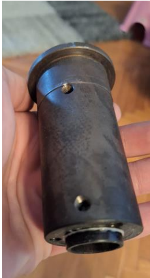
Slika 2.7 – Komora za plastiku nakon testiranja
