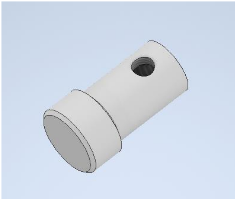
Slika 2.4 – Čep za centriranje klipa
