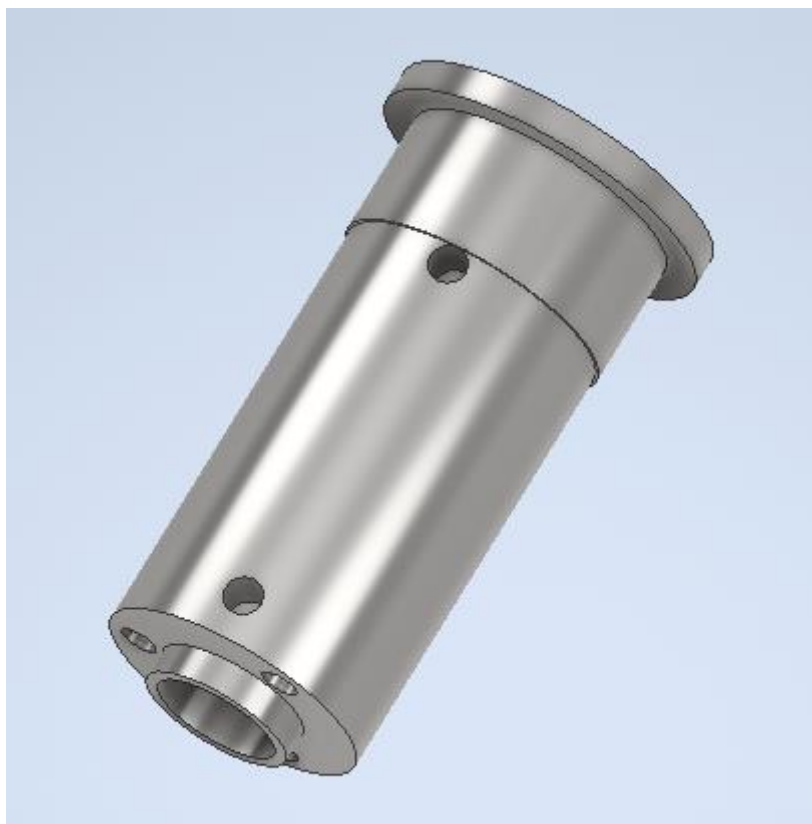
Slika 2.6 – Komora za plastiku
