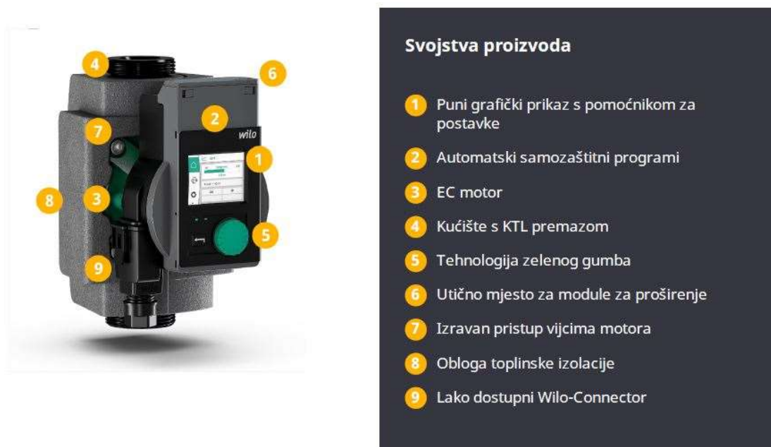
Slika 3.2.3 – Svojstva testirane crpke [3]
