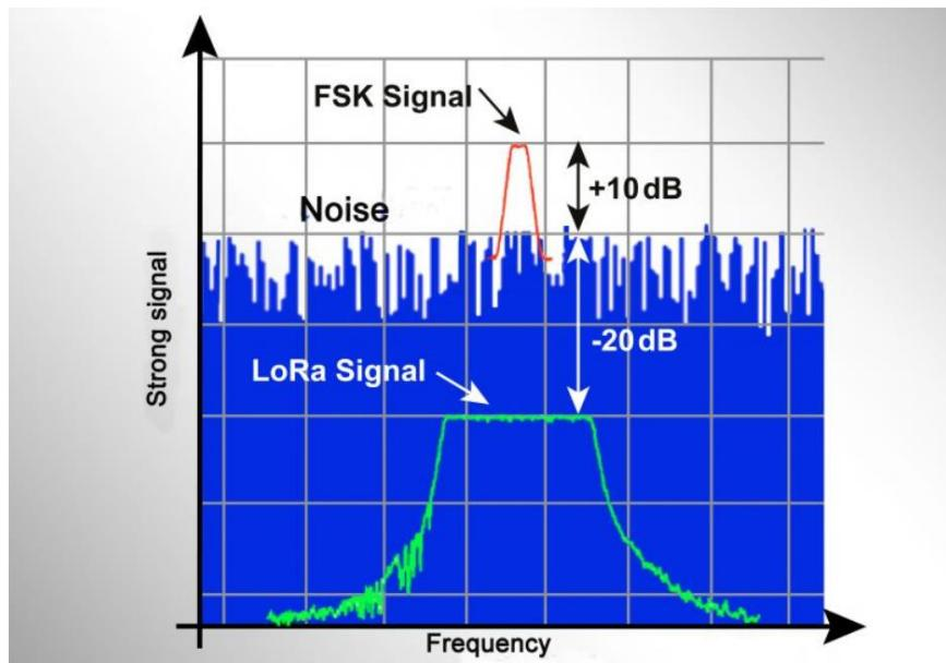
Slika 2.3. Razlika LoRa signala i klasičnog FSK signala.[6]
