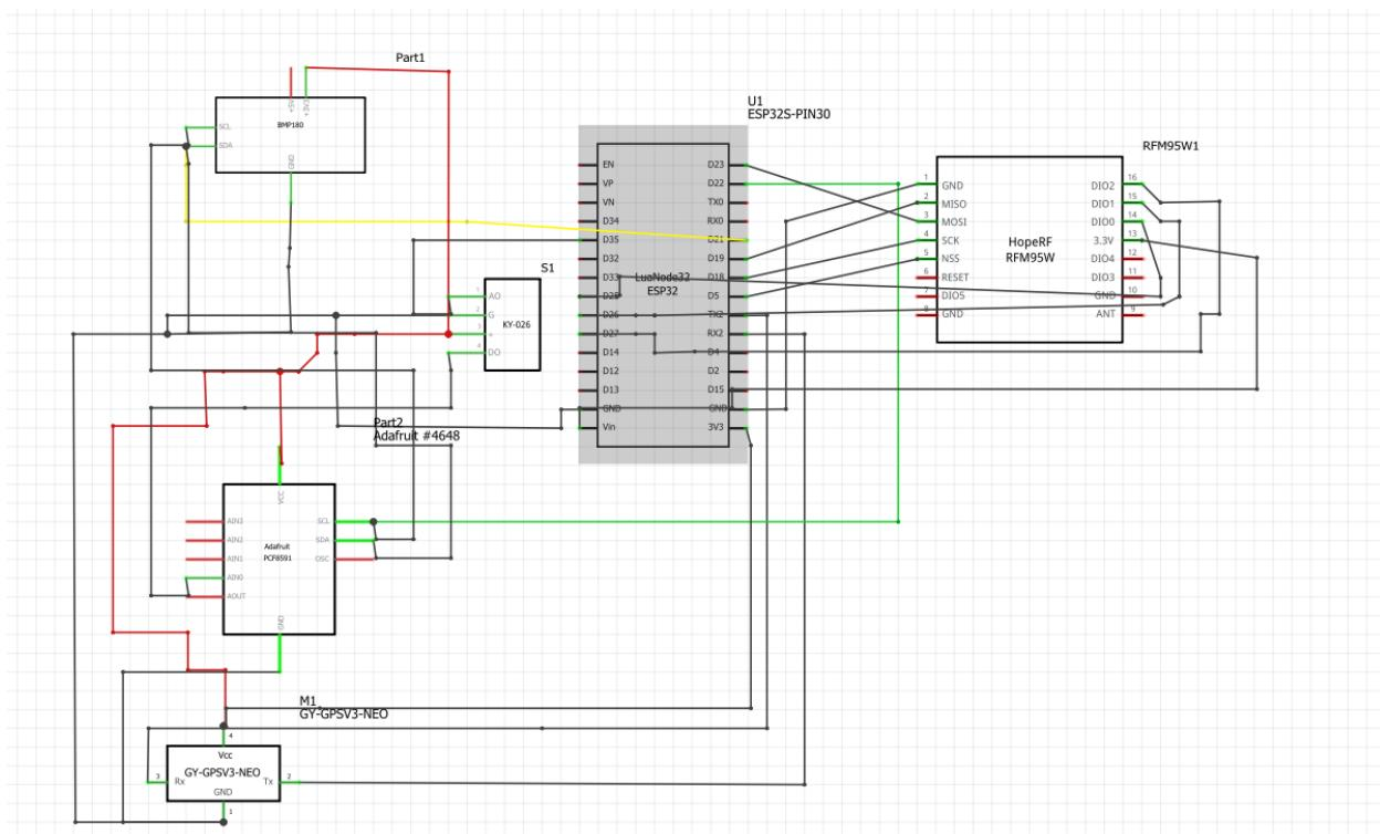
Slika 6.10. Schematic shema sklopa napravljen u fritzing programu.
