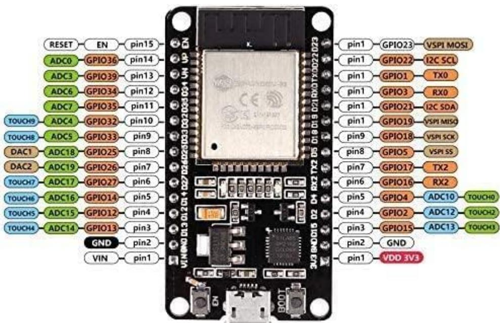
Slika 3.3. Funkcije pojedinih pinova na ESP-WROOM-32 modulu.[20]
