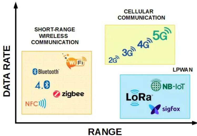
Slika 2.6. Usporedba tehnologija gledajući domet i brzinu prijenosa.[19]
