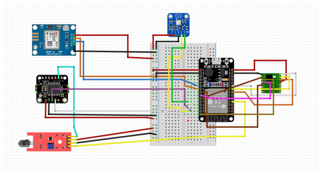
Slika 6.9. Board shema sklopa napravljen u fritzing programu.
