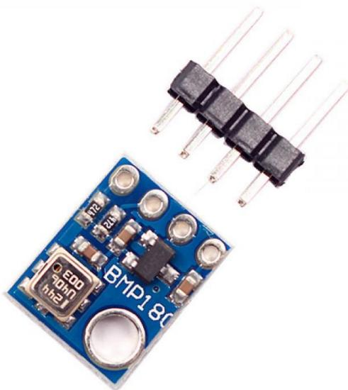
Slika 6.1. Barometar BMP180 [24]
