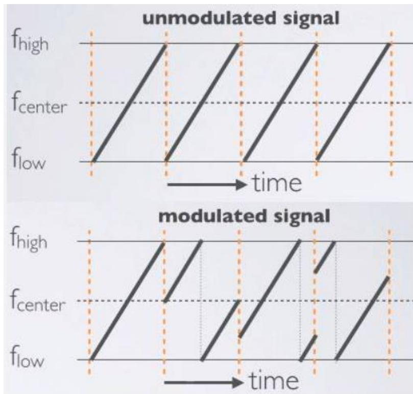
Slika 2.1. Izgled signala u CSS modulaciji. [18]
