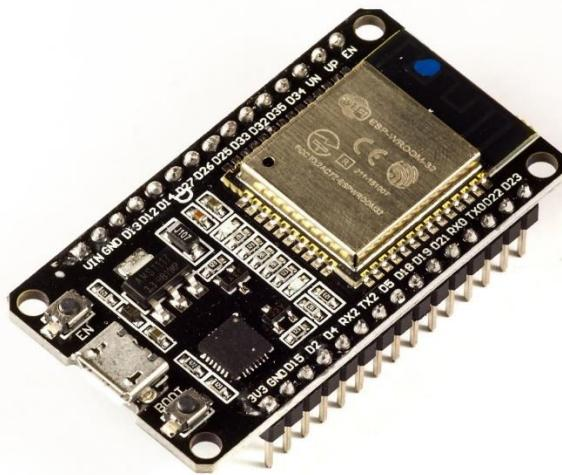
Slika 3.1. Izgled ESP32 pločice[11].
