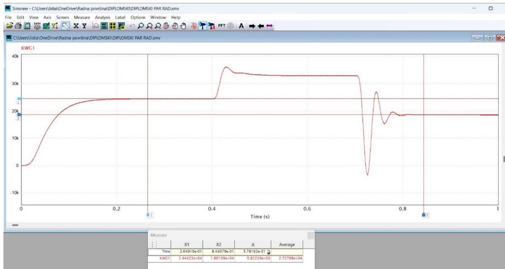
Slika 30. Djelatno opterećenje dizel generatora 1. [8]
