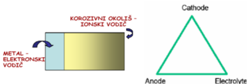
Slika 1. 5. – Elementi potrebni za nastanak elektrokemijske korozije [1]
