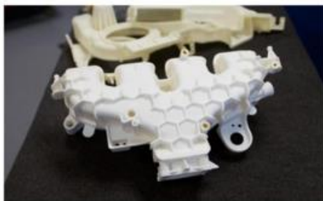
Slika 2. 27. – Kompleksan funkcionalan dizajn kanala otisnut u SLS najlonu [22]
