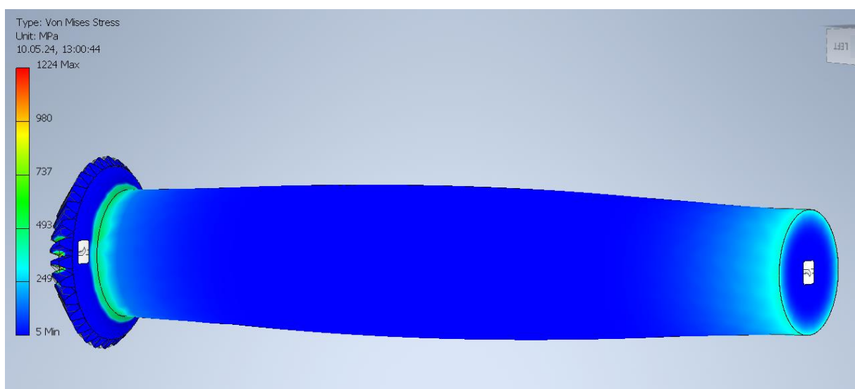
Slika 4.7- Opterećenje ulaznog vratila diferencijala
