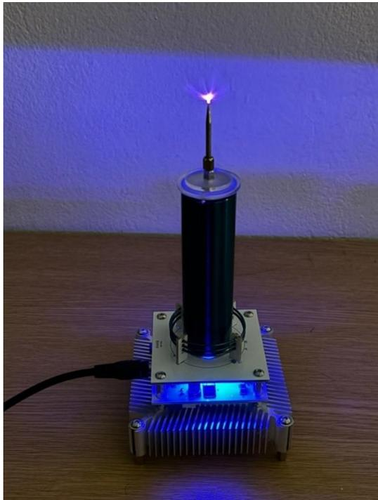
Slika 5. 5: Iskrište zavojnice
