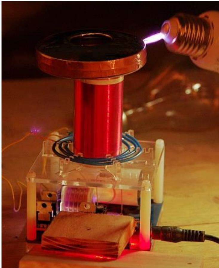
Slika 3. 4. - Teslina zavojnica sa iskrištem (izvor: <http://handsmagic.cc/sqtc06/>)
