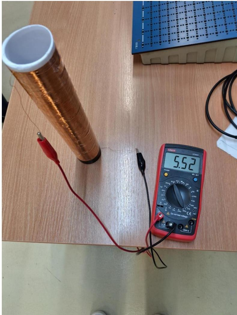
Slika 4. 3: Multimetrom izmjereni induktivitet
