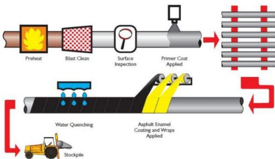
*Slika 5.4 Shema procesa nanošenja asfaltnih premaza [25]*
