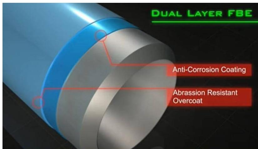
Slika 5.8 Dvoslojni epoksidni premaz spojen fuzijom [24]
