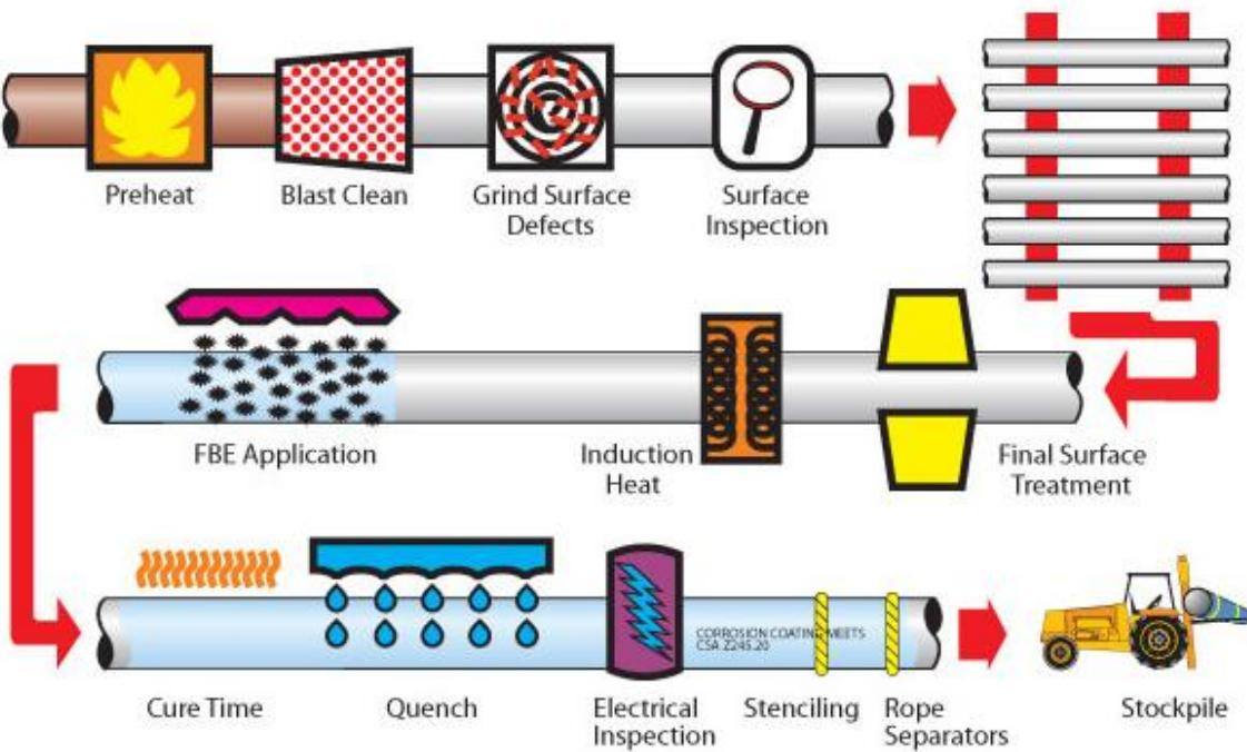
Slika 5.6 Shema procesa proizvodnje epoksidnog premaza spojenog fuzijom [24]
