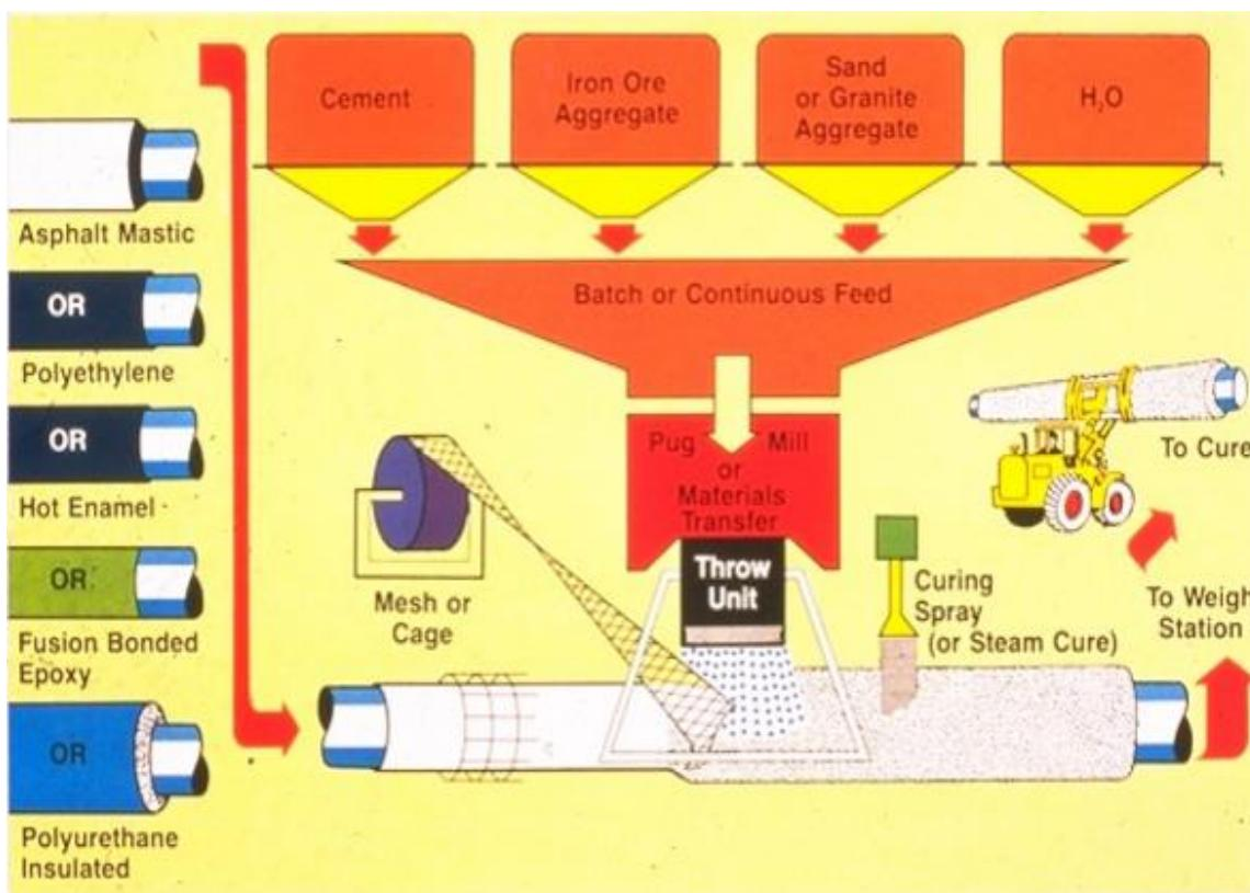
Slika 5.12 Shema procesa proizvodnje betonskih obloga cjevovoda [23]
