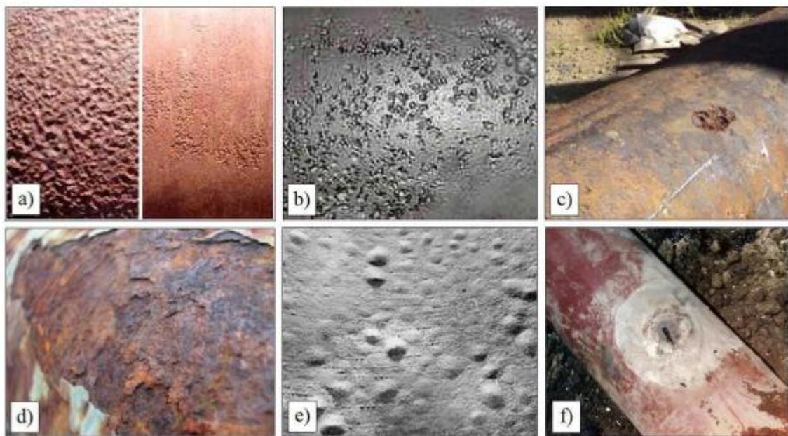
*Slika 4.2 Prikazi karakterističnih oblika vanjske korozije ukopanih cjevovoda: a) Opća korozija; b) Rupičasta korozija; c) Jamasta korozija; d) Korozija ispod naslaga; e) Delaminacija-bubrenje; f) Korozija zbog oštećenja obloge [9]*
