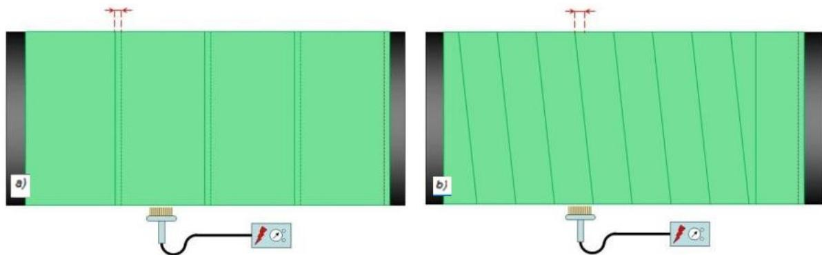
*Slika 5.15 Postupci nanošenja visokoelastičnih premaza; a) Ravno; b) Spiralno [32]*
