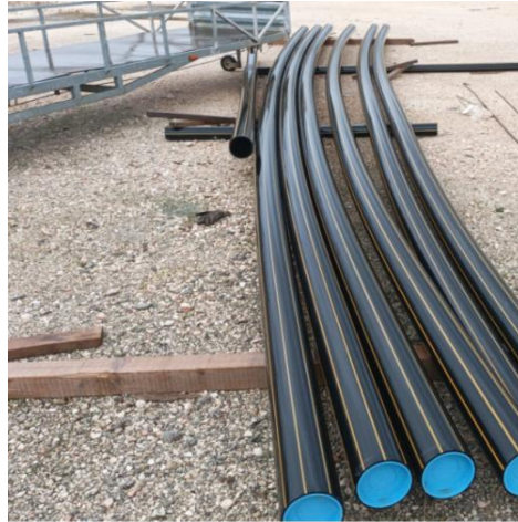
Slika 7.2 PEHD plinske cijevi [44]
