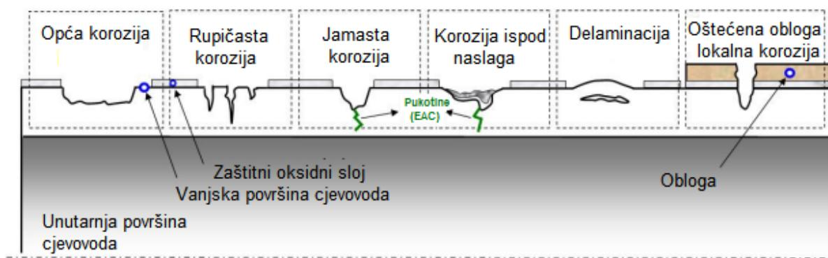
Slika 4.1 Karakteristični oblici vanjske korozije golih i obloženih cjevovoda [9]
