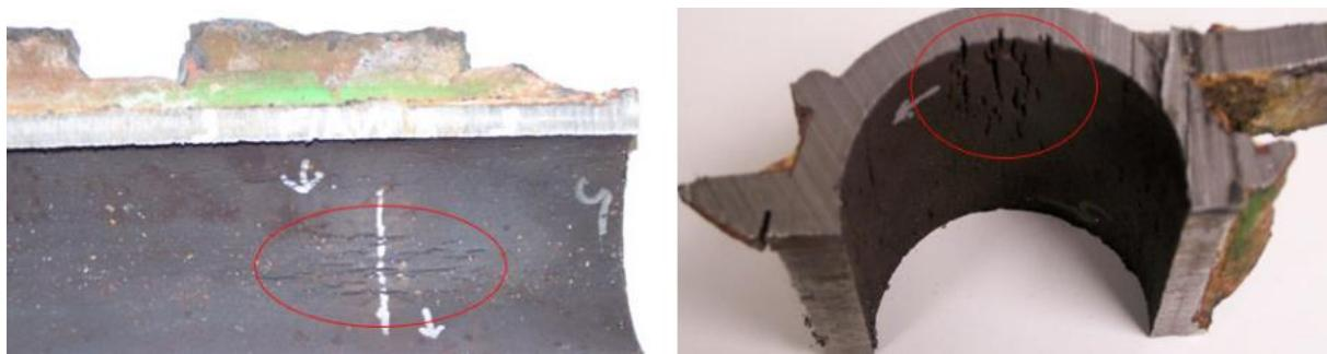
Slika 4.3 Pukotine cijevi izazvane zamorom [19]
