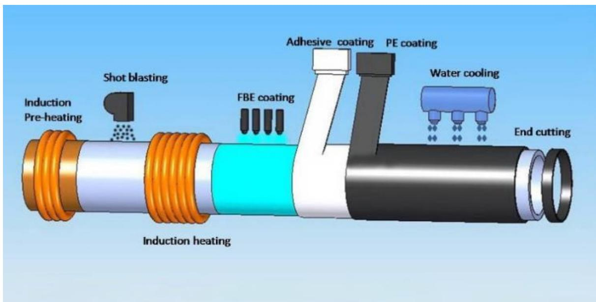
Slika 5.10 Shema procesa proizvodnje troslojne polietilenska/polipropilenska prevlake [27]
