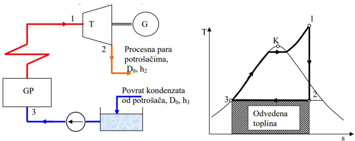
Slika 3.12. Shema protutlačne turbine s prikazom u T-s dijagramu
