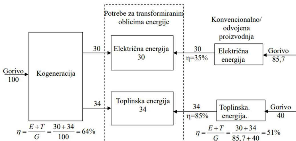
Slika 3.8. Usporedba proizvodnje električne i toplinske energije kogeneracijom i u odvojenim procesima
