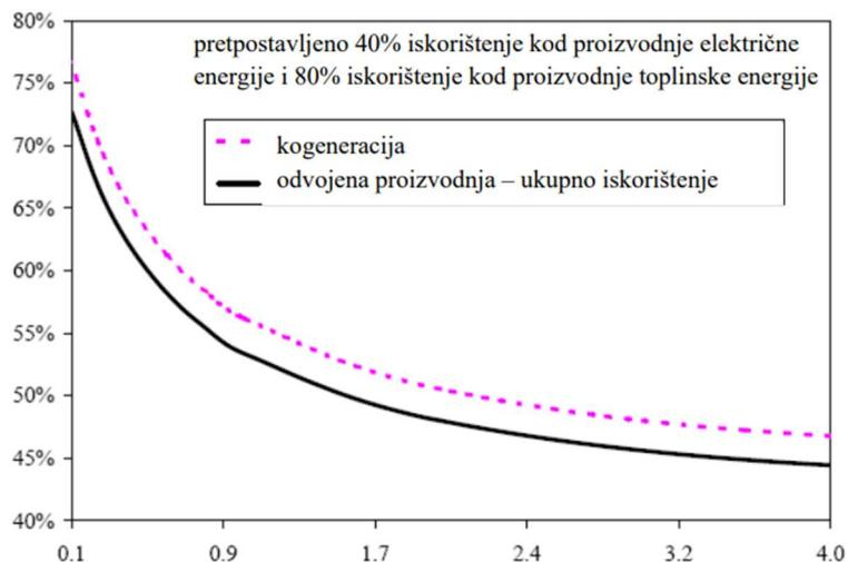
Slika 3.15. Usporedba iskorištenja proizvodnje električne i toplinske energije
