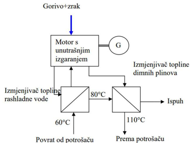
Slika 3.13. Kogeneracijsko postrojenje s motorom s unutarnjim izgaranjem
