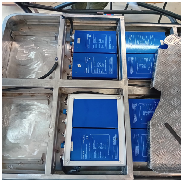
Slika 3.1. Prikaz ugradnje baterija
