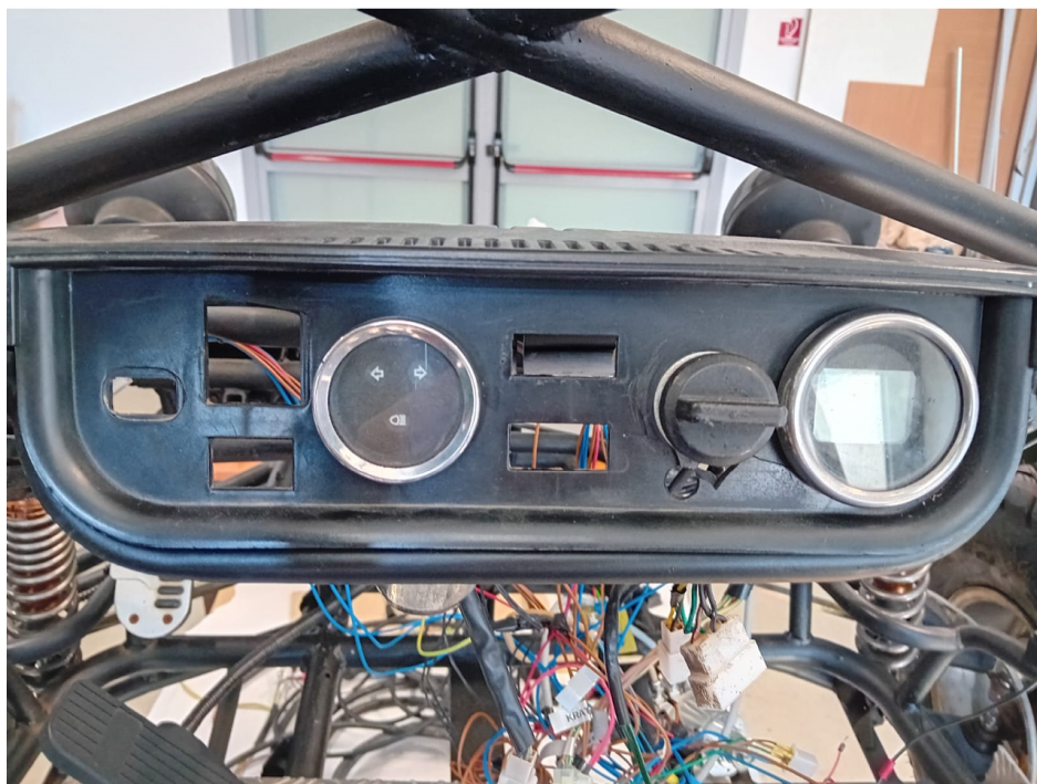
Slika 4.3. Kontrolna ploča u fazi sastavljanja
