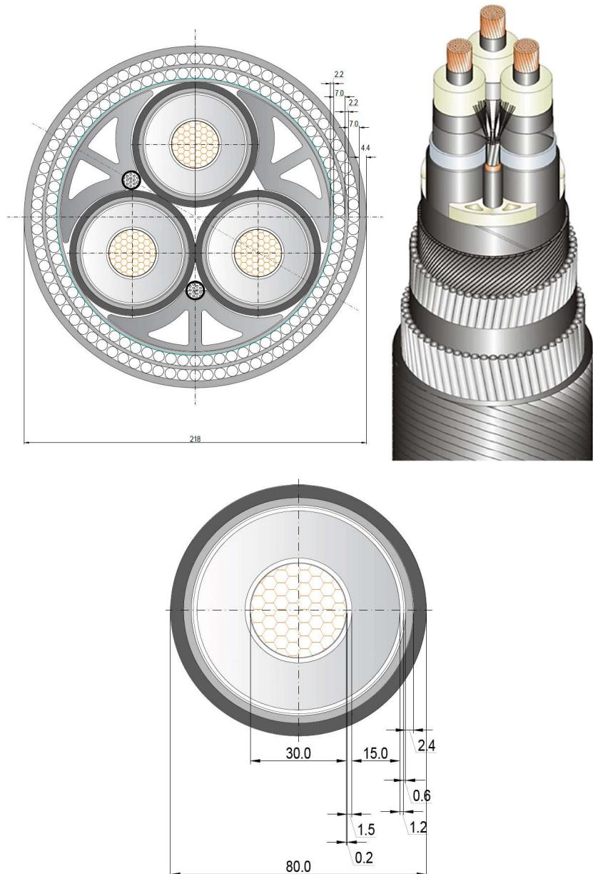
Slika 5.1. Poprečni presjek trožilnog (3C) podmorskog kabela s Cu vodičima presjeka 630 mm<sup>2</sup> prema Production and Supervision of 110 kV Cable Lines in Croatia - Cables Design Report HELLENIC CABLE
