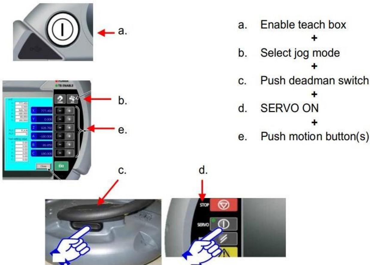
Slika 2.8 Postupak pokretanja robota pomoću TB-a
