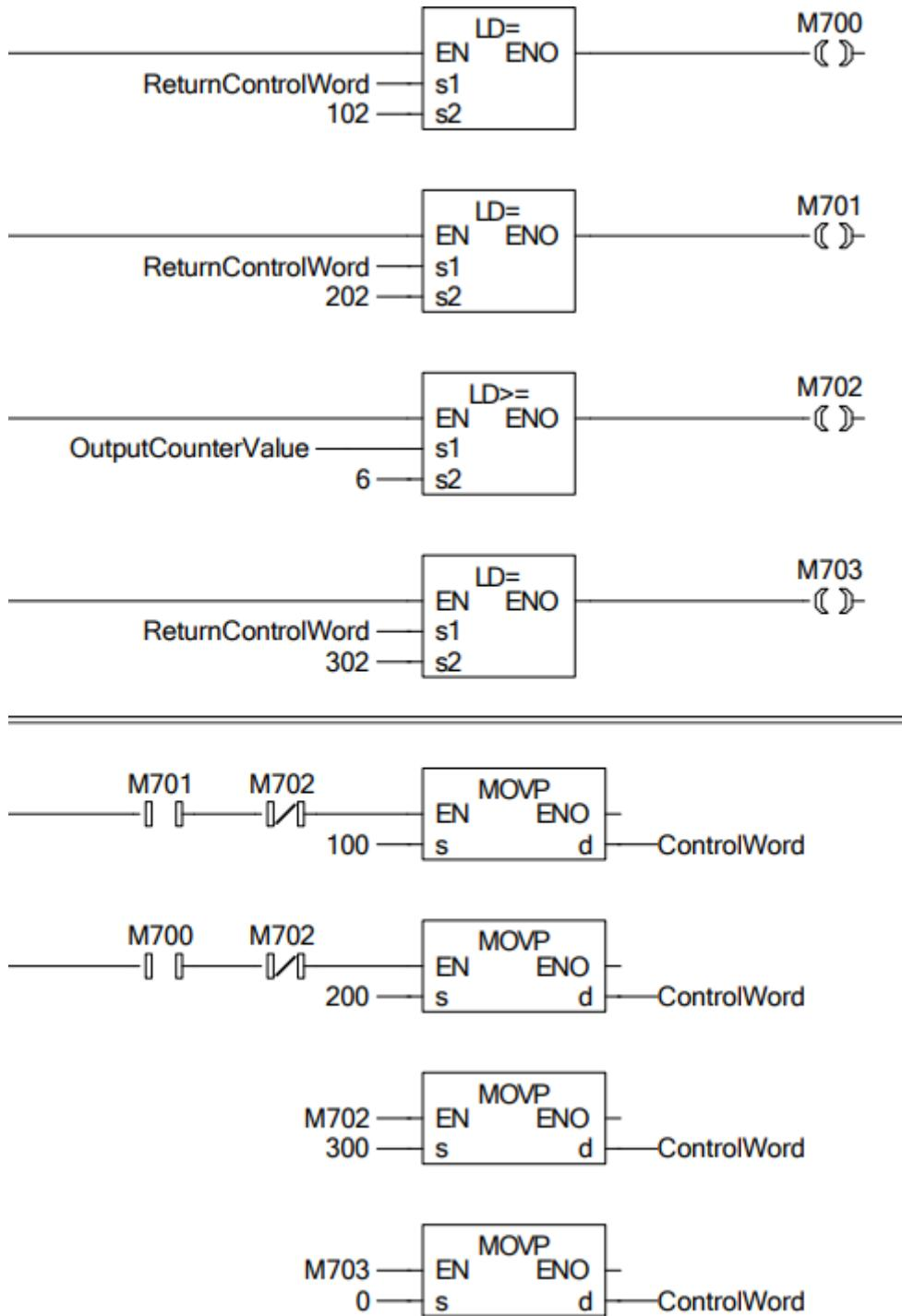
Slika 3.3 Upravljanje robot programima pomoću PLC-a
