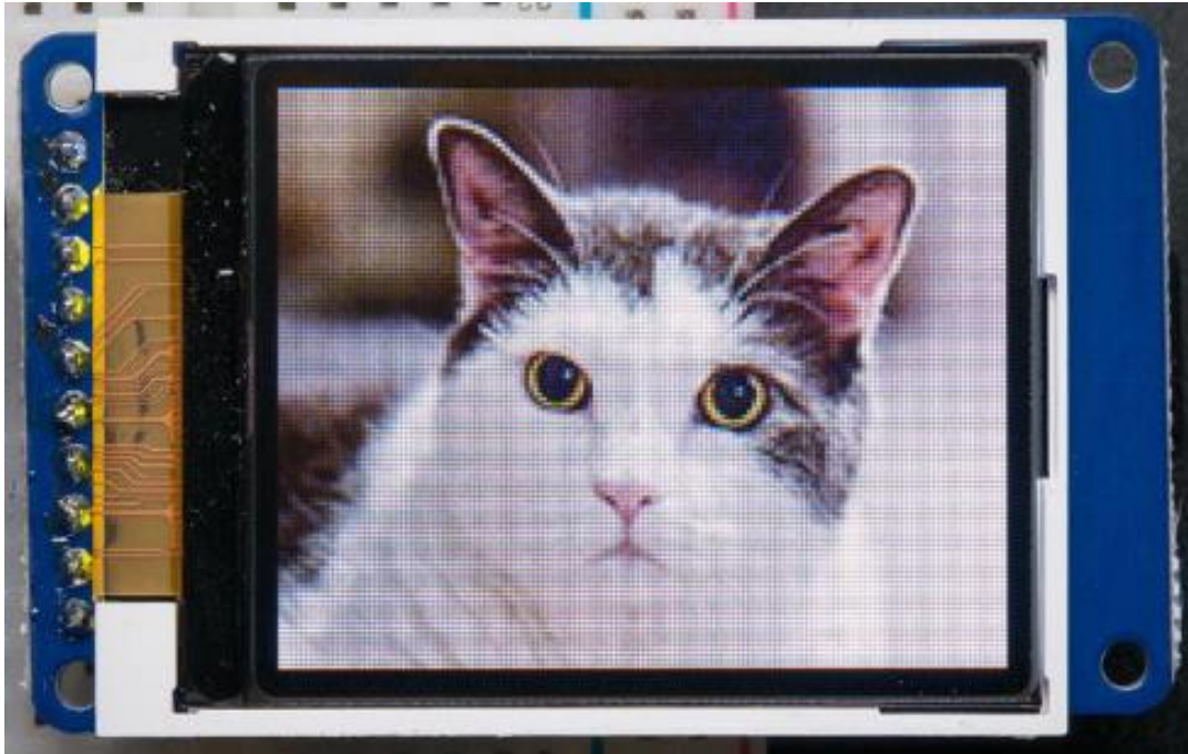
Slika 2.2. Prednji prikaz 1.8" TFT ekrana [4]
