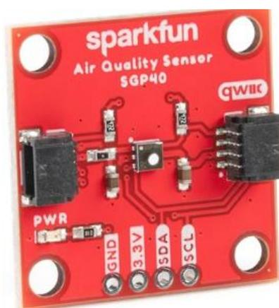
Slika 6 – SGP40 Senzor kvalitete zraka
