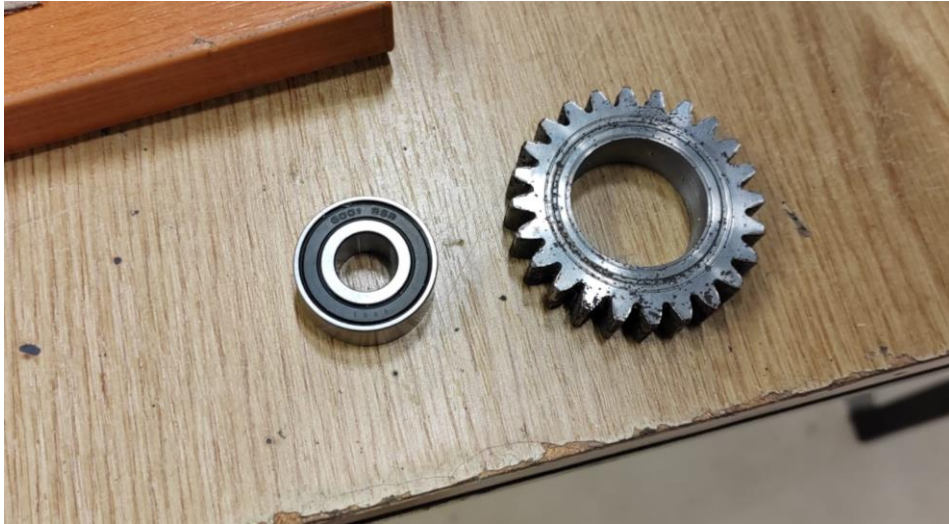
Slika 4.14-Zupčanik prilagođen za novi ležaj
