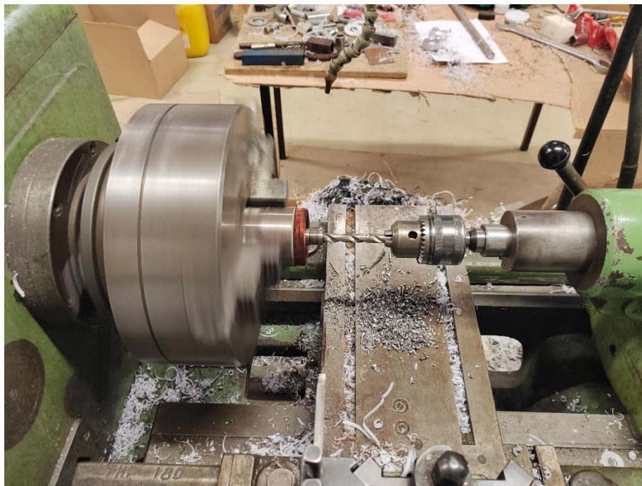
Slika 2.5-Bušenje prednjeg rukavca ležaja
