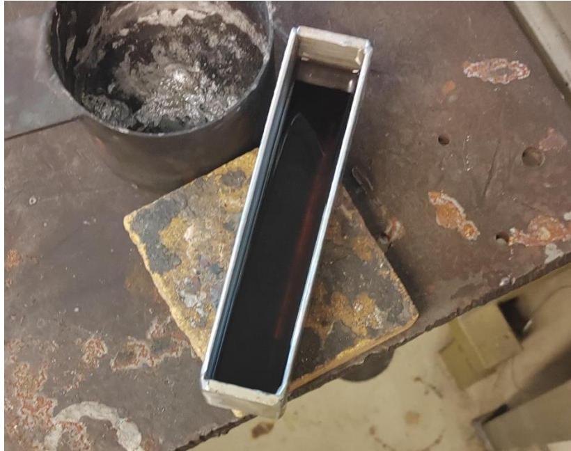
Slika 4.11-Vratilo u posudi s uljem
