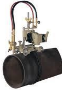
Slika 2.2 – Uređaj za plinsko rezanje [2]
