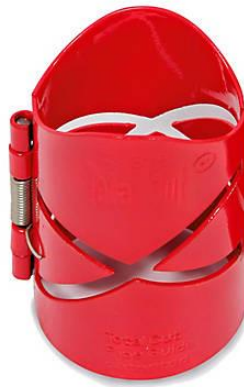
Slika 2.1 – Šablona za izrezivanje sedla [1]
