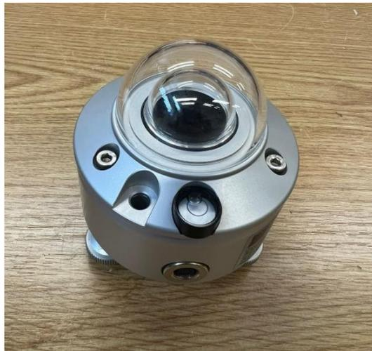
Slika 7.1. Piranometar SMP 10-A
