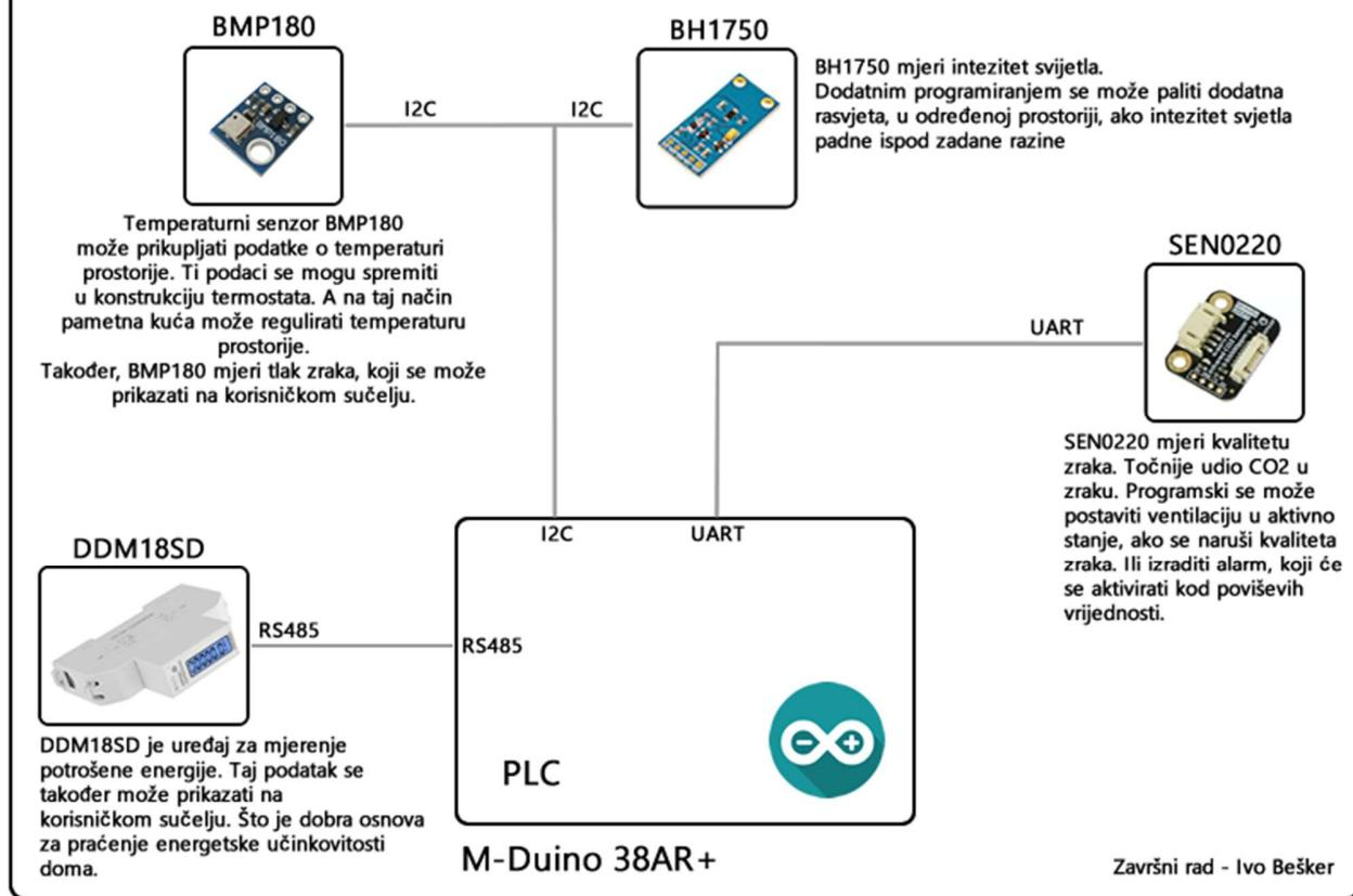
Slika 2.1 - Mogućnost spajanja senzora u sustavu pametne kuće
