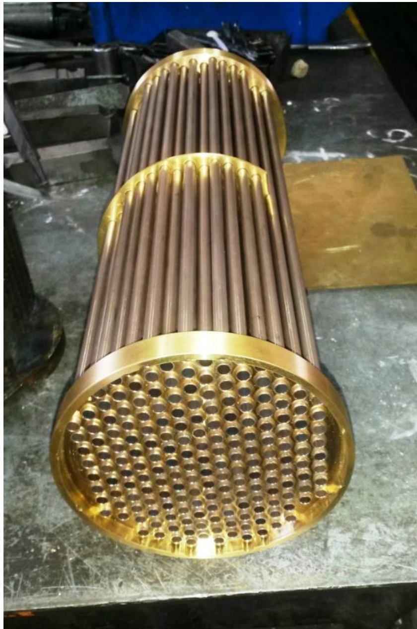
Slika 1.1 - Izmjenjivač topline s cijevima i ljuskom[1]
